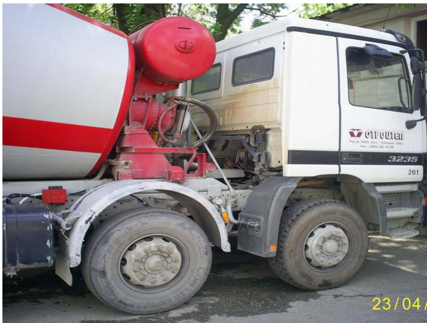
Фиг. 1. Общ вид на бетоновоза с вграден расходомер
