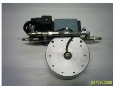
Fig. 2 – Illustration of a flow-meter type RTG2 and of a sample location for inbuilding it in the fuel-feeding system of the engine / Общ вид на разходомер тип РТГ2 и на примерно място на вграждане в хранителната система на двигателя
