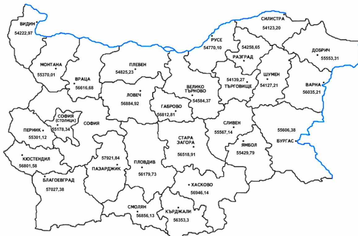
Фиг. 7. Разпределение на стойностите на количеството изкуствено осветление за допълване на недостатъчното дневно естествено осветление при плавно управление на вътрешни осветителни уредби в периода, когато се използва смесено осветление (за помещение с критична естествена осветеност 5000 lx в различни географски пунктове в България)
