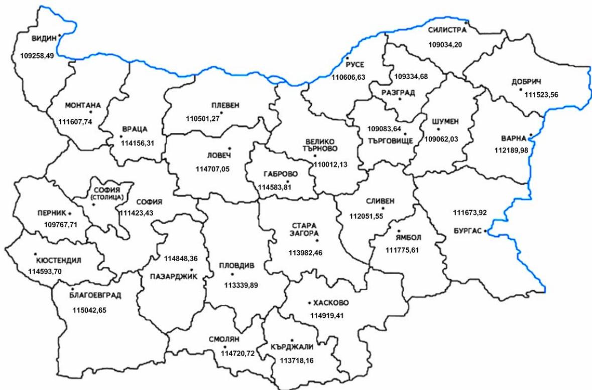
Фиг. 8. Разпределение на стойностите на количеството изкуствено осветление за допълване на недостатъчното дневно естествено осветление при едностепенно управление на вътрешни осветителни уредби в периода, когато се използва смесено осветление (за помещение с критична естествена осветеност 5000 lx в различни географски пунктове в България)
