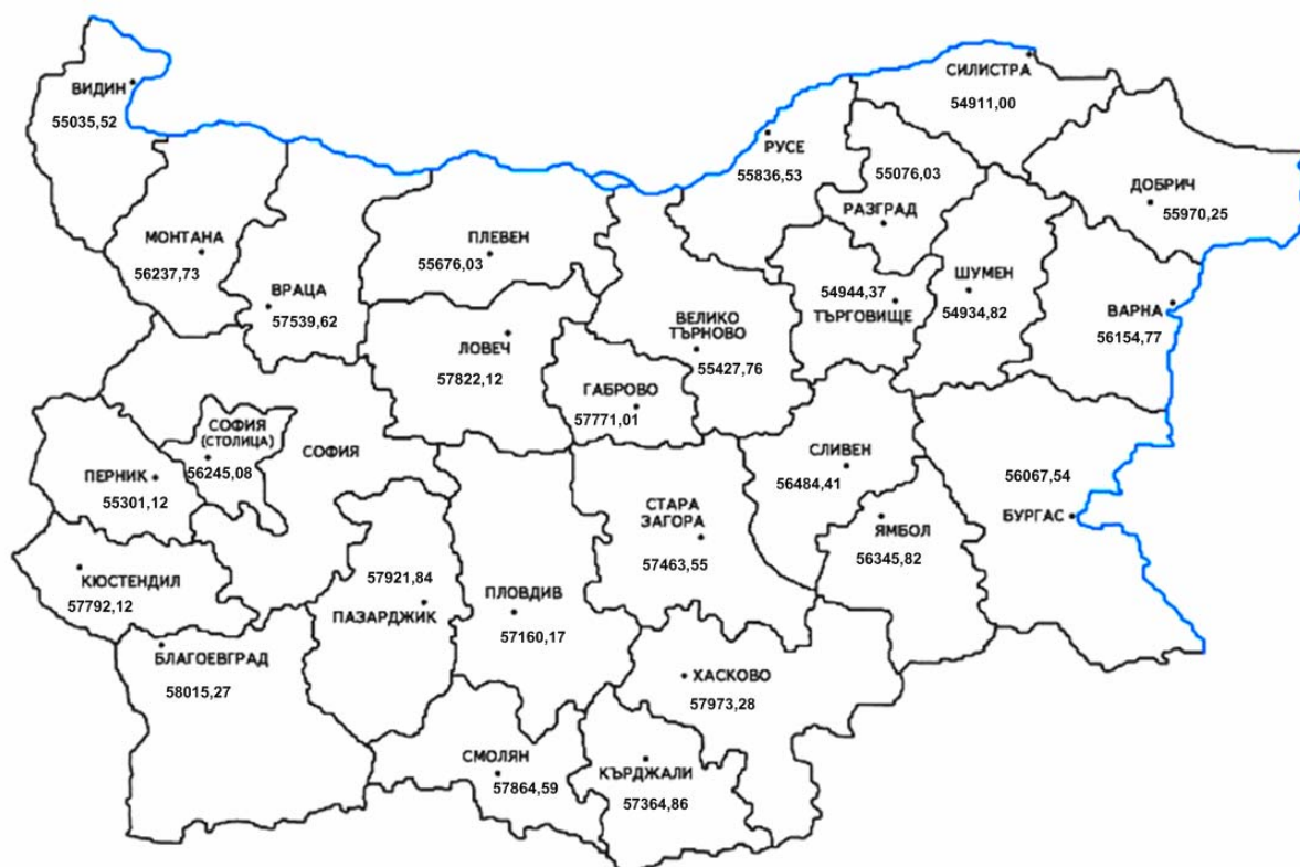
Фиг. 6. Разпределение на стойностите на разполагаемия потенциал на дневното естествено осветление вътре в помещението през периода от денонощието, когато дневното естествено осветление се допълва с изкуствено (за помещение с критична естествена осветеност 5000 lx в различни географски пунктове в България)
