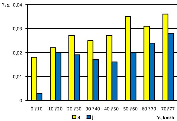
Фиг.12. Относителни разлики в ускоренията в зависимост от скоростния режим регистрирани от IMU02 и VBOX 3i.
