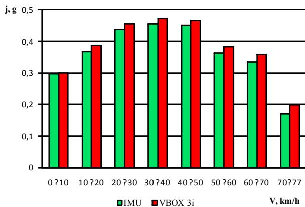
Фиг.11. Спирачни закъснения в зависимост от скоростния режим регистрирани от IMU02 и VBOX 3i.
