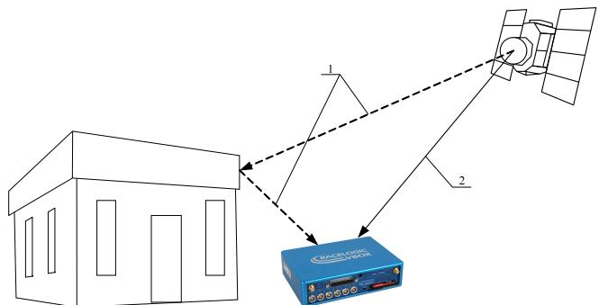
Фиг.2. Отразяване на сигнала от сателита в сграда, където 1 – отразен сигнал в сгради; 2 – действителен път на сигнала.
