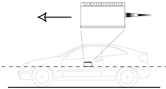
Фиг.7. Разположение на инерционния сензор IMU02 в автомобила.
